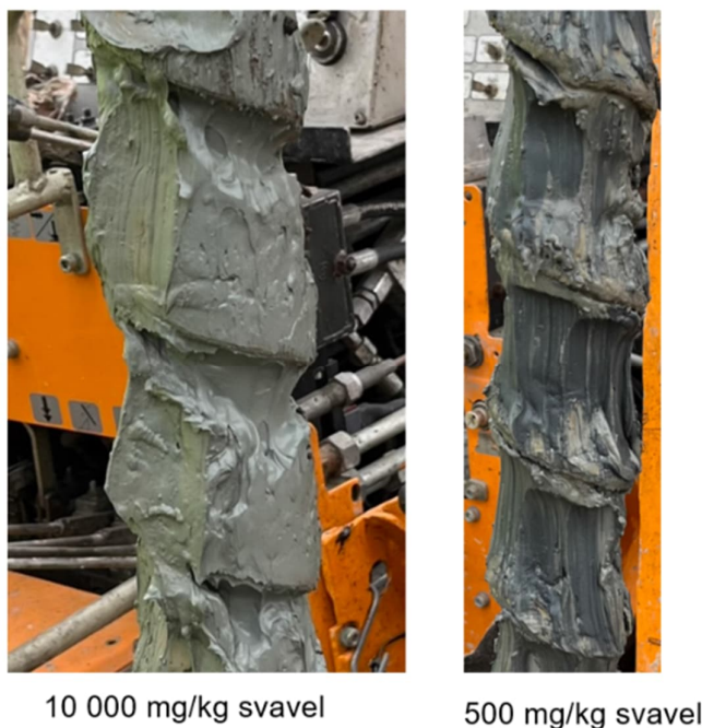
Figur 1 Provtagning i sulfidhaltig lera södra Sverige. Sulfidlera behöver inte vara svart, allt som är svart är inte sulfidlera.
